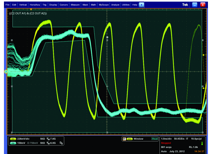
DDR 메모리입니다. DDR3의 특정 비트 패턴에서 간혹 발생하는 쓰기 버스트를 분리하는 데 사용되는 비주얼 트리거입니다. DQ 가 3 상태 이외의 전압 값에서 시작되는 경우 트리거 이벤트는 11000000의 쓰기 DQ 버스트입니다. DDR 메모리 버스 이벤트에는 클럭, 스트로브, 데이터 채널 및 여러 진폭, 데이터 버스트 등이 포함됩니다.
