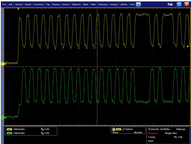
성능 - 최대 2GHz 아날로그 대역폭 및 10GS/s 샘플링 속도까지 유효 충실도 및 100ps 해상도로 USB2.0 480Mb/s 차동 신호를 캡처합니다.
